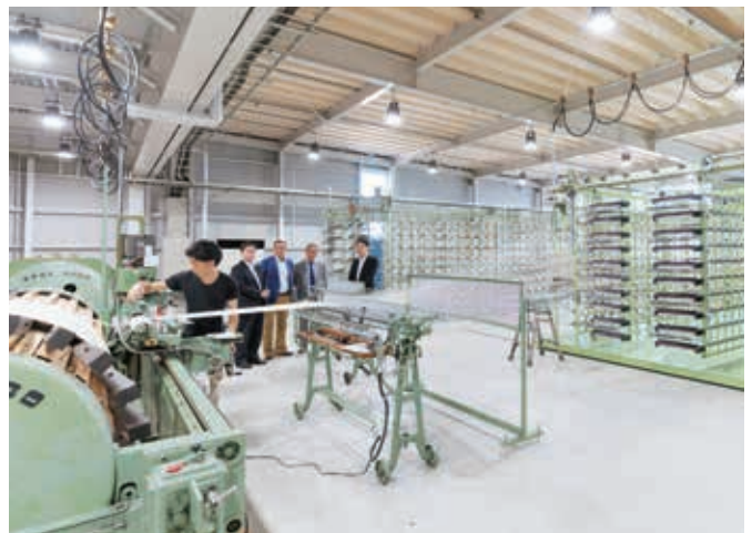
稲沢工場内の整経機
