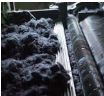
反毛 細かく裁断した古着を小さな針のついたローラーでワタ状にする。
