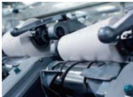
ワインダー 精紡で出来た糸を何本もつなぎ合わせながら一定の長さで巻き取る。
