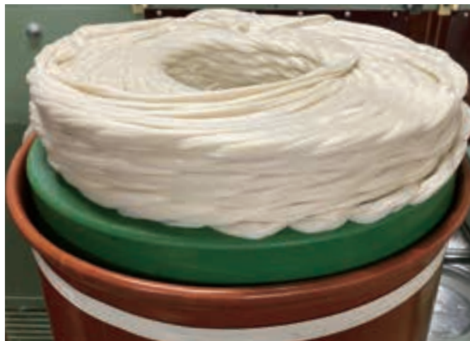
練条機(左) 繊維を1本ずつ解きほぐして作った繊維の束(スライバー)を束ね合わせる。練条工程を経たスライバーは繊維の向きがそろい太さも均一になる(右)。
