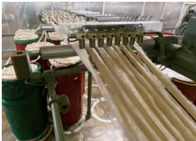
練条機(左) 繊維を1本ずつ解きほぐして作った繊維の束(スライバー)を束ね合わせる。練条工程を経たスライバーは繊維の向きがそろい太さも均一になる(右)。
