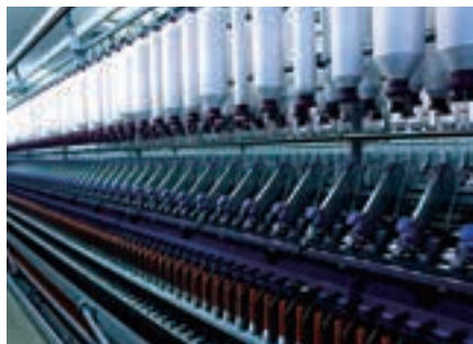
精紡機 スライバーを引き抜きながら細くし、撚りを加えて糸の形にする。
