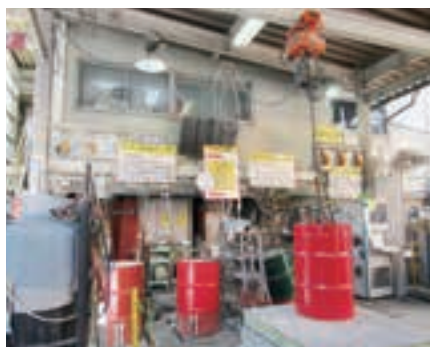
フロンは専用の容器に移し替えられ、石灰焼成炉に送り込まれる。
