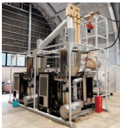
木質バイオマスガス化発電システム 発電と熱供給を同時に行う熱電併給システムで、小型でもエネルギー効率が良い。
